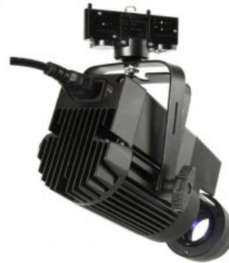
MiniDisplay est un projecteur de gobo rotatif à LED. Il est équipé d'un module de LED blanche d'une puissance de 30W permettant de recevoir un gobo d'une taille de 38mm (taille image 28mm), équipé d'une optique 17° et d'un focus manuel. MiniDisplay peut fonctionner de manière autonome ou être commandé en DMX ou via l'application IOS ou Android et l'AirBox (compatible BoxKolor et PcKolor).
