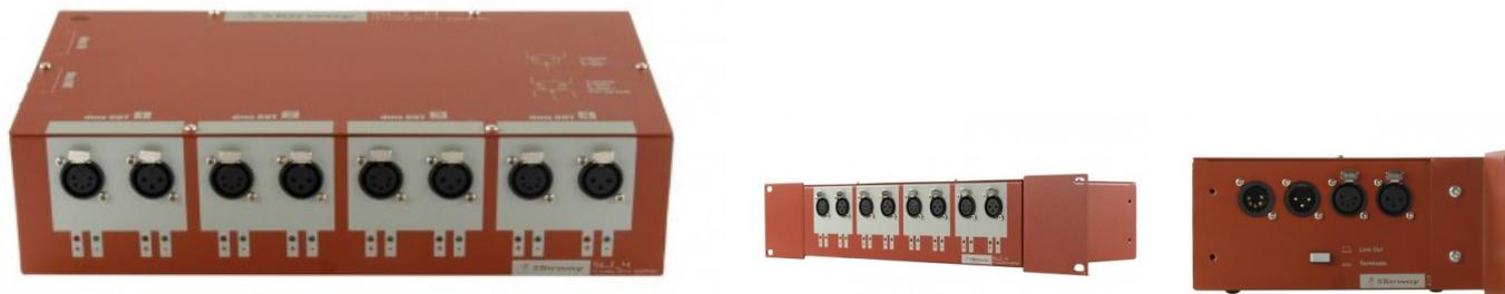
SLI 4 est un splitter DMX 4 sorties amplifiées avec isolation opto-électronique, protégées contre les surtensions. Entrée/sortie DMX 512 connecteurs s XLR 3 et 5 broches.
