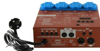
DLI 416 est un bloc de puissance 5 A par canal. Charge maximum totale : 20 A. Utilisation sur tout type de charge résistive ou selfique. 16 programmes internes. Fonctions : manuel, dimmer ou automatique.
