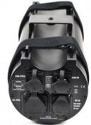
SLI 6 RDM-IP est un splitter DMX 6 sorties sur XLR 5 broches compatible RDM. Entrées et sorties protégées électroniquement. Protection contre les surtensions. S'intègre directement sur une structure grâce à sa forme adaptée et sa certification IP65. Livré dorénavant en finition noire.
