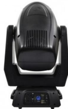
Servo Blade 15K est la nouvelle déclinaison du ServoSpot 15K qui embarque désormais un bloc rotatif de 4 couteaux. équipé d'une led 420W, c'est un projecteur automatique spot/couteaux rapide et silencieux. Il dispose d'un système linéaire de trichromie CMY et d'un CTO progressif, d'une roue couleur 9 positions, d'une roue de gobos rotatifs 8 positions et d'une roue de gobos fixes 7 positions. Il est également doté d'un zoom de 7 à 50°, d'un iris, d'un prisme 3 facettes et d'un frost.
